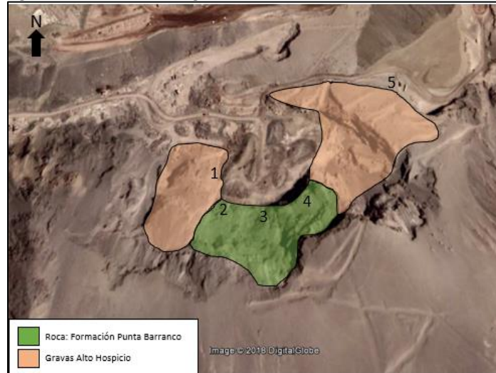
Figura 11-22: Sectores geotécnicos identificados en Cantera 6
